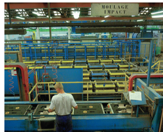
Chantier de moulage sable 800 x 600 mm ± 250.
